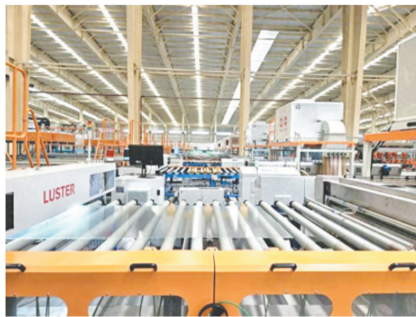
弘诺玻璃生产车间光伏压延玻璃下线
