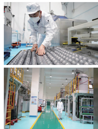
在中核北方高温气冷堆核燃料元件生产线上,工作人员正在认真检查球形燃料元件。
