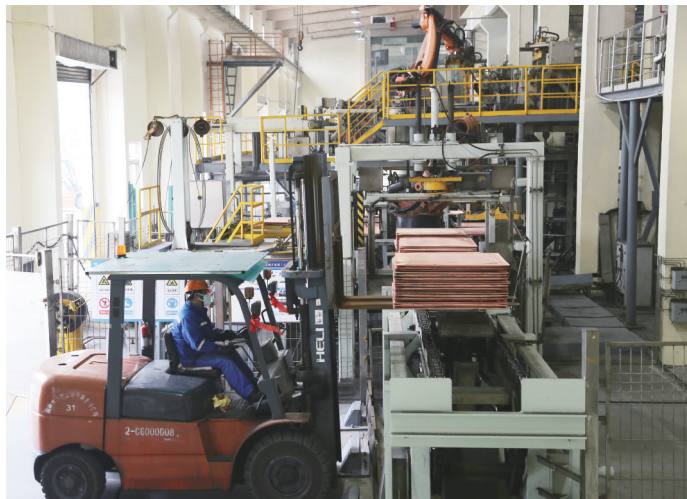
安徽省属企业铜陵有色金属集团金冠铜业分公司产出的高纯阴极铜正从剥片机组运输架上铲运下线 吴家富/摄
