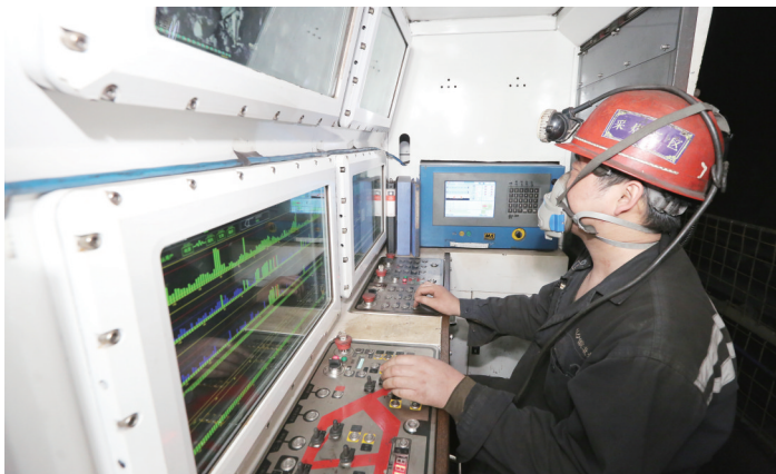
皖北煤电职工在集中控制室远程操控采煤机组设备采煤 梁勇/摄
