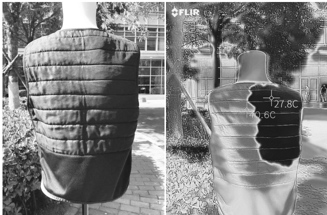
测试效果对比图 右图低温区为加水区域
