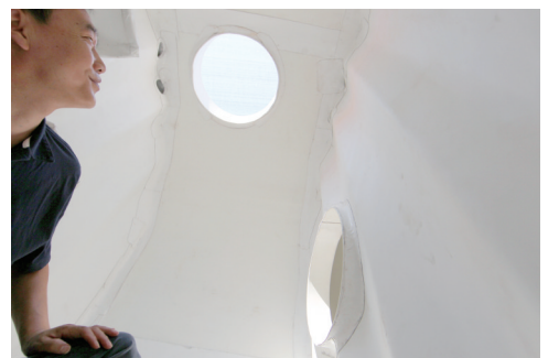
应用了双防材料后的槽罐车内部。传统的滚塑技术产生隔绝层的厚度是1.5—2厘米,而双防材料的隔绝层厚度仅为0.15毫米。
