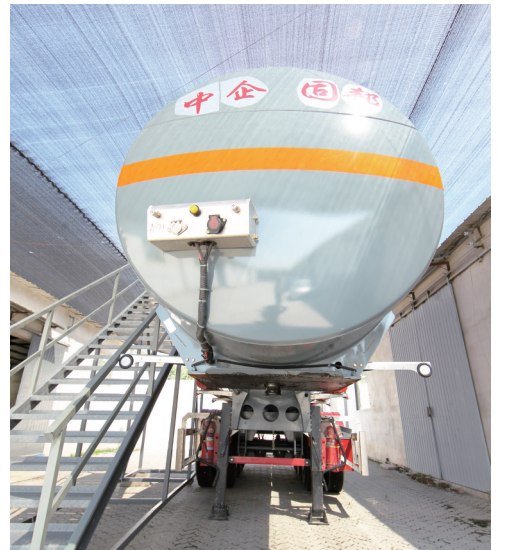
国内首辆应用高分子防腐材料槽罐车通过技术检测,并投入运营。
