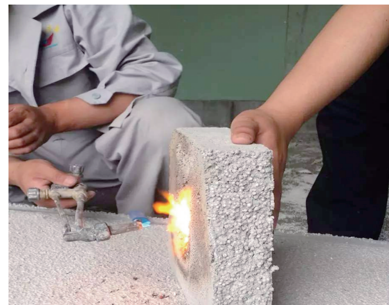
在一侧遭遇火焰燃烧过程中，基体不但不分解，还能长时间保持应有的机械强度，并可有效阻止火焰的高温渗透。3000摄氏度火焰攻击，背面无热感。
