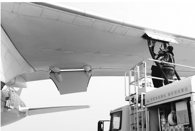
中国石化1号生物航煤产品加注到波音787型飞机上 胡庆明/摄
