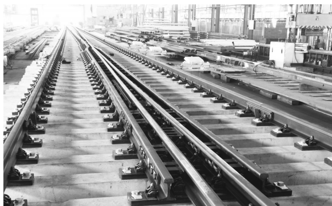
中铁宝桥自主研发时速350公里60-42有砟高速道岔
