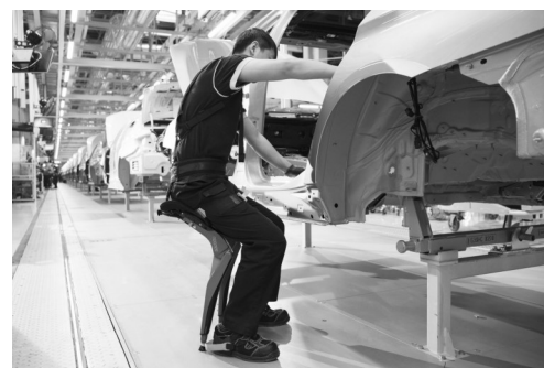
“工业4.0”应用机械外骨骼(无座椅)
