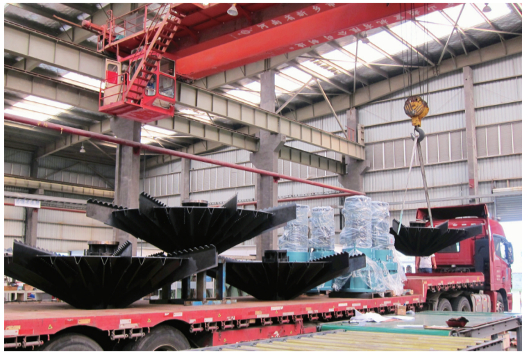
正在装车发往现场的倒伞曝气机
