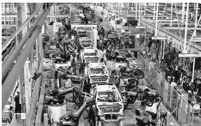
天津市福臻装备有限公司引进高端装备焊接生产线
