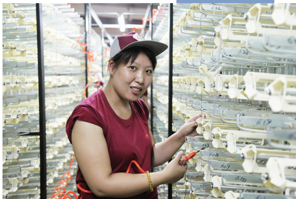
高温下,阿克明织架操作员工在进行新织机穿送绒纱的工作
