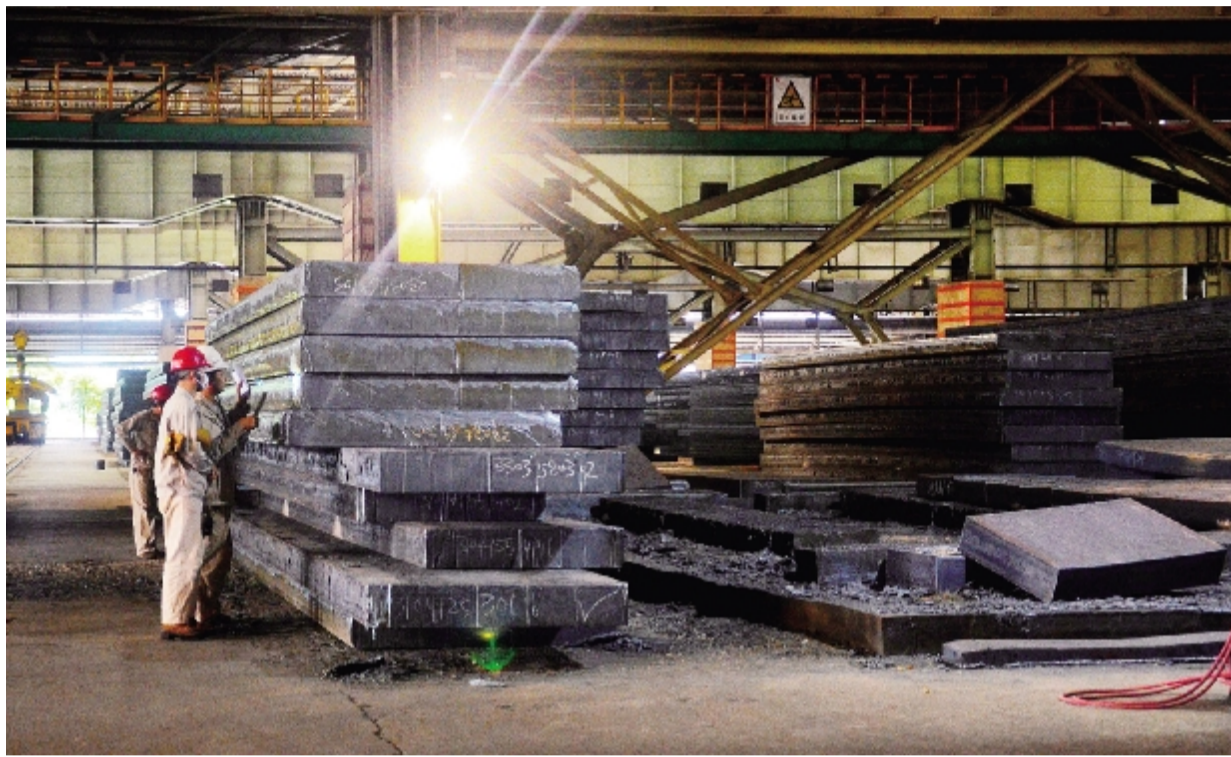
马钢新区四钢轧总厂钢区操作人员正在细致确认铸坯表面质量 黄永安 上善中 秦军/摄
