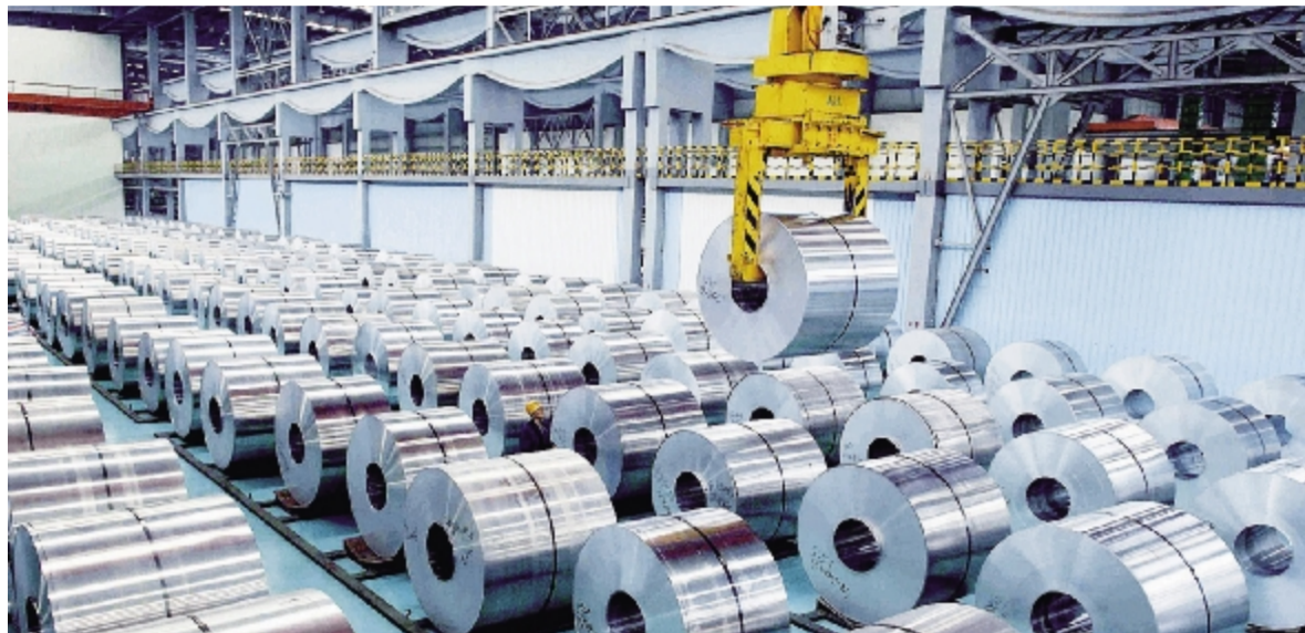
中铝公司用于全铝易拉罐制罐材料的热连轧大卷
