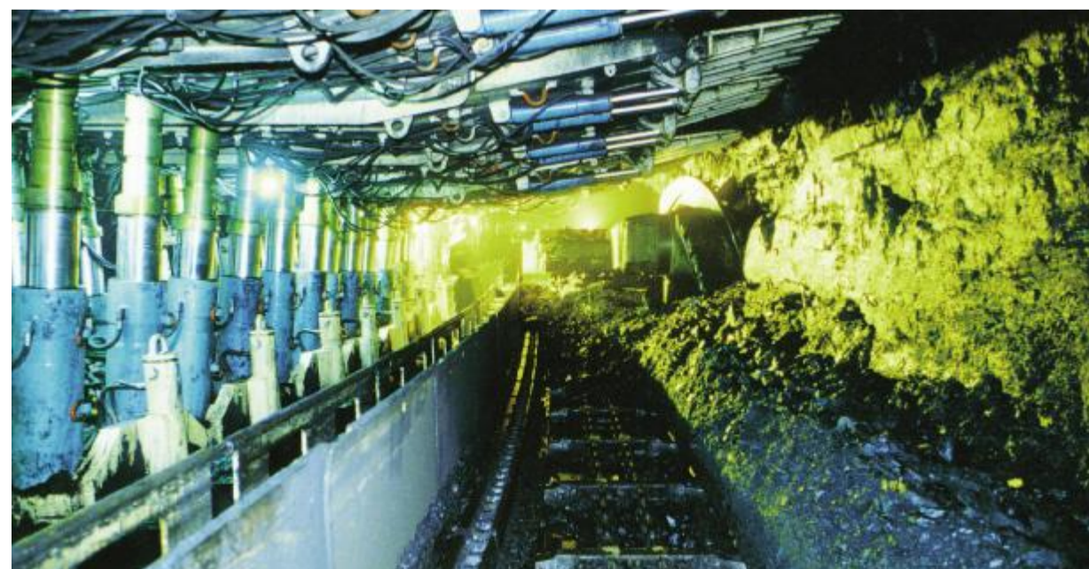
瓷矿集团具有国际领先水平的综采放顶煤工作面
