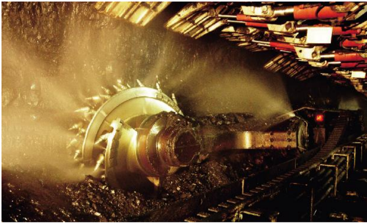
中煤平朔井工矿综采工作面
