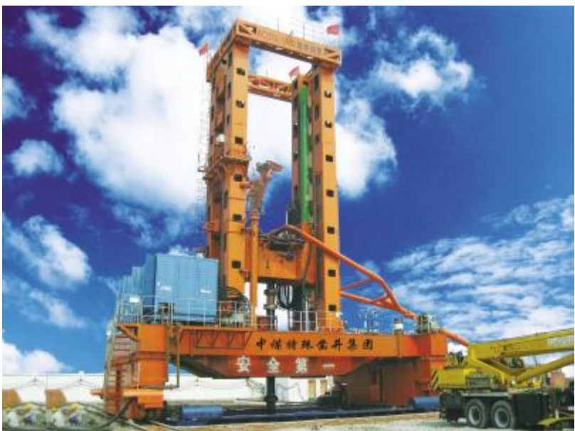
集团AD130-1000型竖井钻机为亚洲最大的竖井钻机
