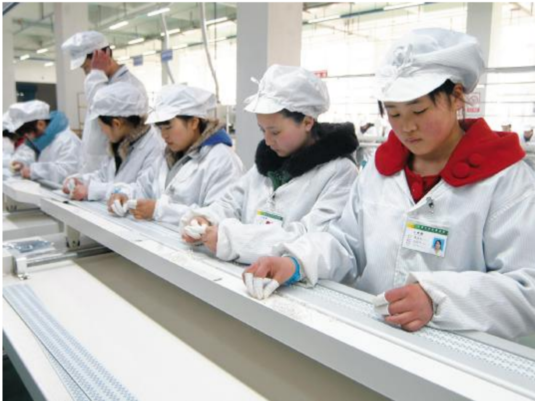
“北川—山东产业园”内,一家电子公司的工人正在流水线上安装LED节能灯灯珠插件。该公司今年1月正式投产,年产LED节能灯750万只,产值4.5亿元。自2010年以来,该园区加强对入驻34家企业新招本土工人的技术培训,目前已解决当地就业岗位3000余个。成和平/摄
